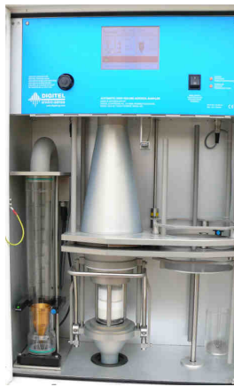
Figure 14 : Couplage filtre, mousse polyuréthane et résine sur le préleveur haut débit
