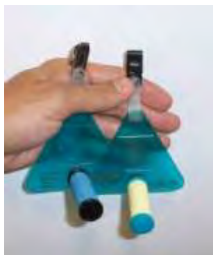
Figure 2 : Exemple de tubes à diffusion passive (Radiello 165 à gauche, Radiello 145 à droite)
