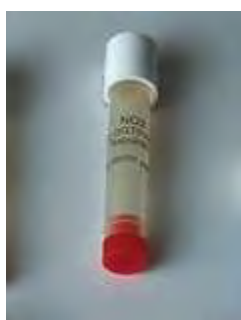
Figure 5 : Echantillonneur passif de NO 2 - Passam
