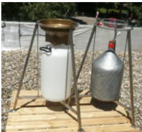
Dispositif de mesure de retombées atmosphériques : Jauges Owen
