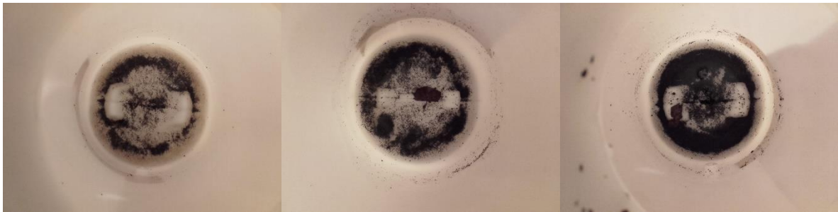
Visuels des éléments récupérés dans les jauges Owen dans les trois lieux de mesures après 1 mois de prélèvement. (sites n°3 / n°2 / n°1)
