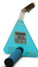
Figure 3 : Radiello 165 : Cartouche 165, corps diffusif bleu et support
