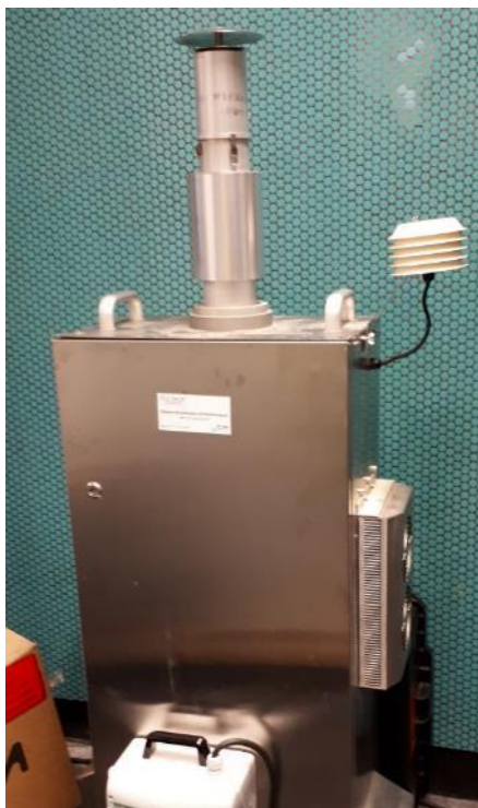
Photographie 5 : Préleveur séquentiel de particules et fines et métaux Leckel (source AtmoSud)
