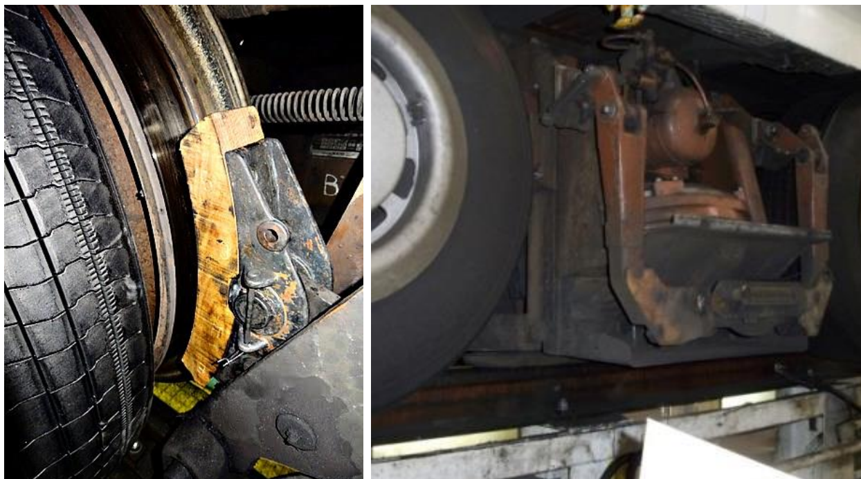
Photographie 1 : Roue pneumatique doublée d'une roue de sécurité fer avec frein mécanique à sabot en bois (source RTM)
