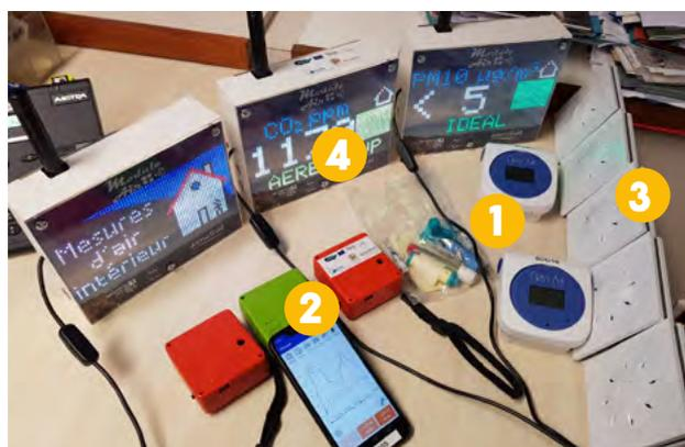
**4 : CAPTEURS PÉDAGOGIQUES DE MESURE ET D'AFFICHAGE** de la qualité de l'air intérieur et extérieur pour rendre les données accessibles et interprétables par tous. Ces capteurs « Module Air », ont pu être développés par AtmoSud dans le cadre du projet Sensorthèque. Solution open source.
