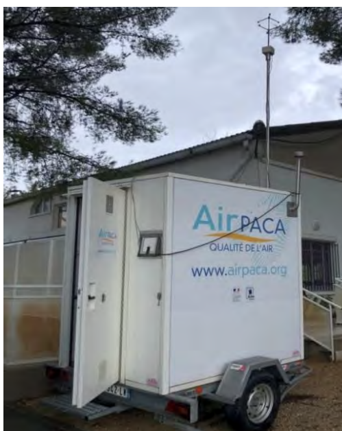
Photographie 4 : Station de mesure mobile (analyseur de COV et station météo)
