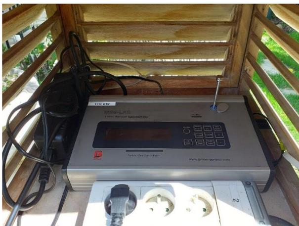
Ces appareils permettent de fournir une information sur le **nombre de particules** de diamètre compris entre 250 nm et 32  $\mu\text{m}$ . De plus, un troisième appareil (MINI-WRAS<sup>1</sup>), semblable à celui présenté ci-dessus, a été installé dans la station de mesure située sur le toit de la DDTM83 sur la même période. Ce dernier permet de fournir une information sur le nombre de particules de diamètre compris entre 10 nm et 32  $\mu\text{m}$ .
