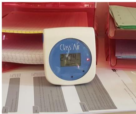
Figure 4 : Appareil de mesure de CO<sub>2</sub>, température et humidité relative : Class'Air
