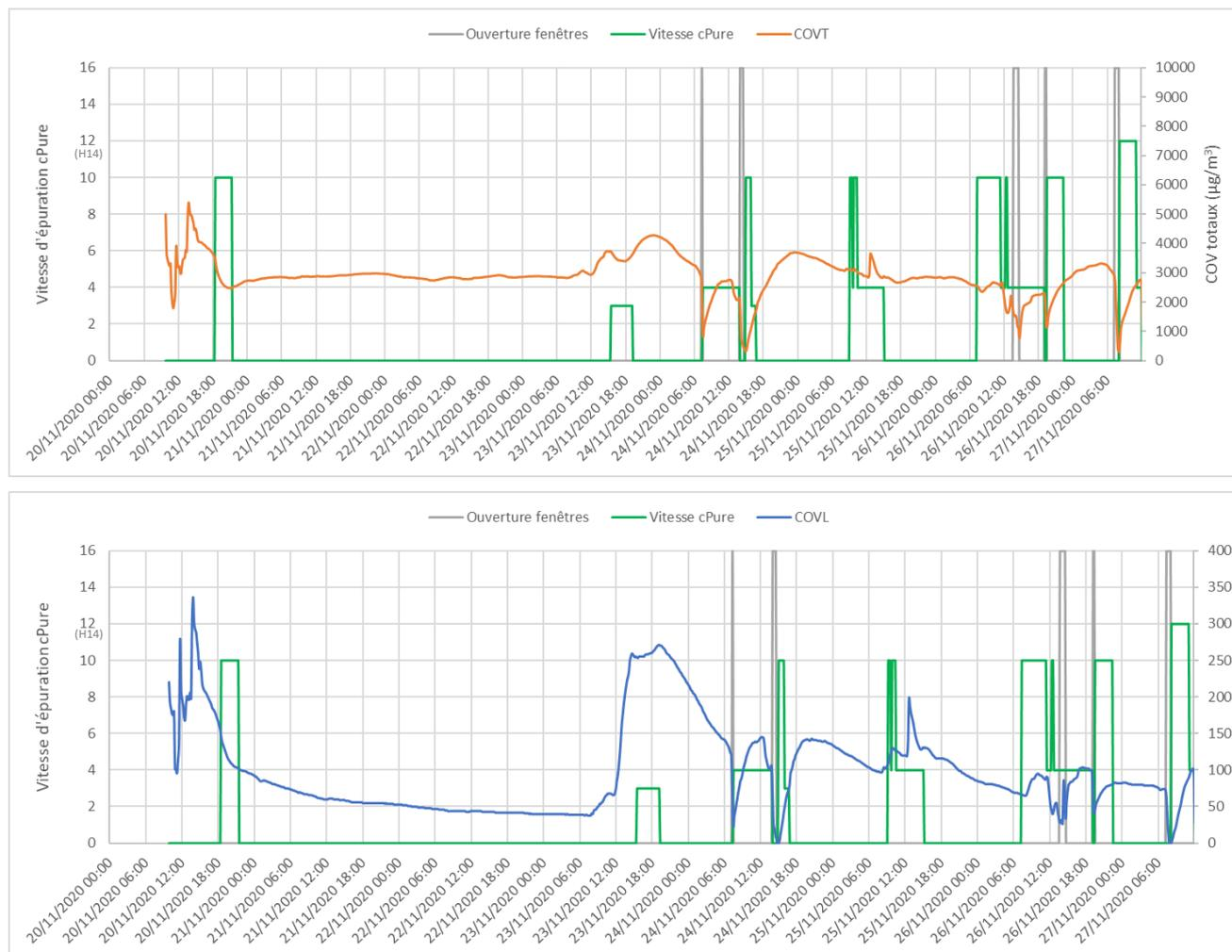
L'épurateur d'air cPure est destiné principalement à l'épuration des particules dans l'air avec des filtres particulaires performants. Pour les composés gazeux, il ne s'agit que d'une pré-filtration par charbon actif dont l'efficacité est négligeable sur les COV au regard de celle de l'ouverture des fenêtres.
