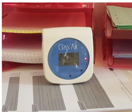
Figure 1 : Appareil de mesure de CO 2 , température et humidité relative : Class'Air
