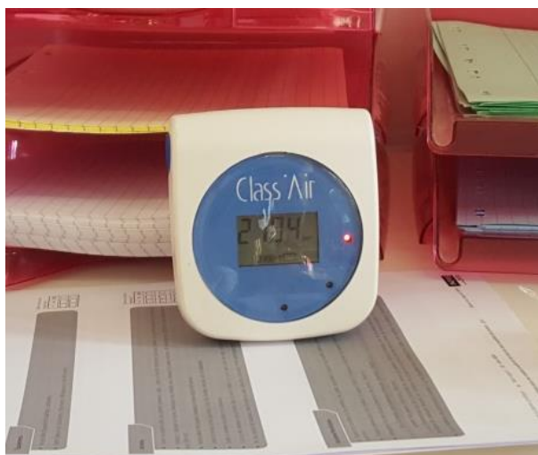
Photographie 5 : Appareil de mesure de CO 2 , température et humidité relative : Class'Air
