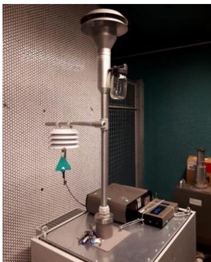
Photographie 2 : Analyseur automatique des particules fines BAM 1020 (source AtmoSud)
