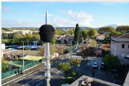
*Le Pays d'Aix a engagé la réalisation d'une nouvelle liaison routière entre la RD65, chemin du Club Hippique et la RD9, qui assurera, entre autre, une liaison périphérique au sud d'Aix en Provence. Une station de mesure du bruit a été installée sur le toit de la mairie annexe du Pont de l'Arc depuis le mois juin 2018, afin d'appréhender les évolutions de l'environnement sonore occasionnées par ce projet.*
