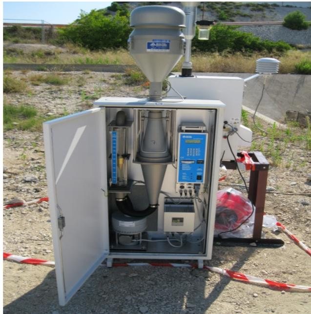
*Figure 25: système de prélèvement Digital - DA 77*
