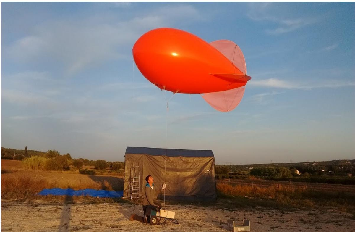
Figure 29 : Ballon captif Vaisala TTB327 au niveau du sol.
