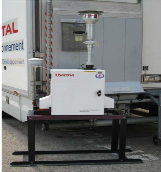
*Figure 24: système de prélèvement Partisol*
