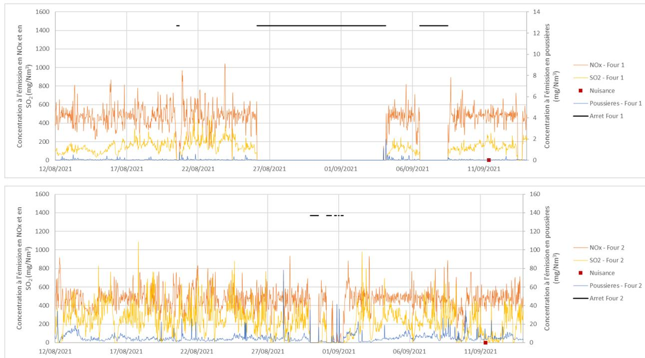
**Figure 66 : Relation entre concentrations à l'émission et signalement de nuisance**
