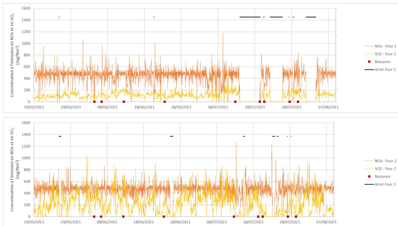
**Figure 23 : Relation entre concentrations à l'émission et signalement de nuisance**
