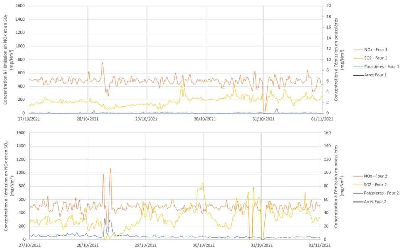
**Figure 110 : Evolution des concentrations à l'émission des fours 1 et 2 entre le 27 et le 31 octobre**
