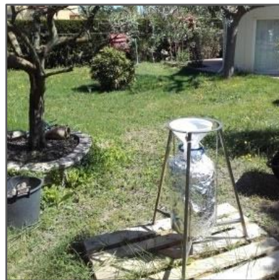
Figure 13 : Jauge Owen installée sur le site de mesures « Mange-Garri 3 »
