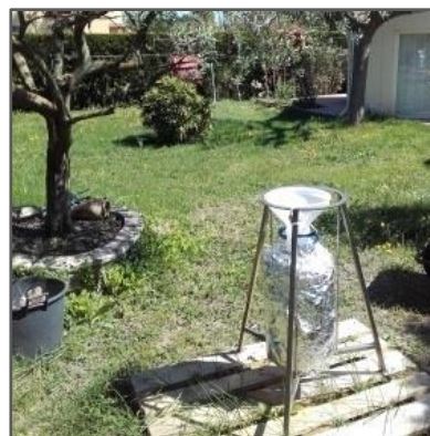
Figure 22 : Jauge Owen installée sur le site de mesures « Mange-Garri 3 »
