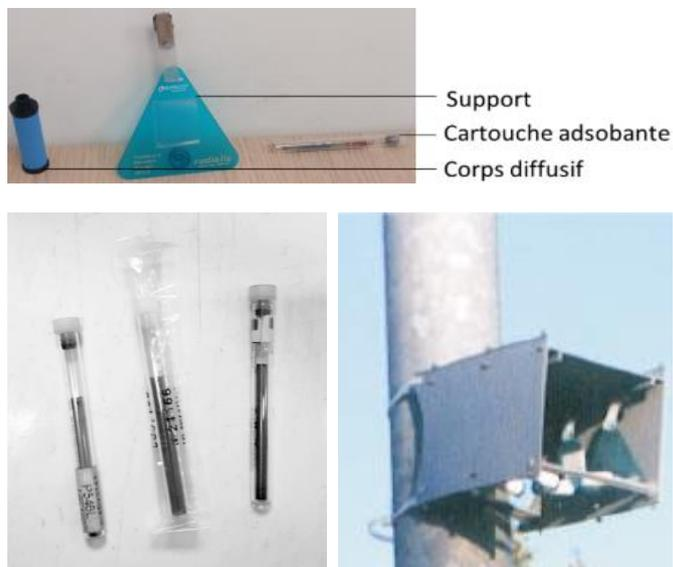
**Figure 4 : Composition du matériel employé pour la mesure de BTEX**
