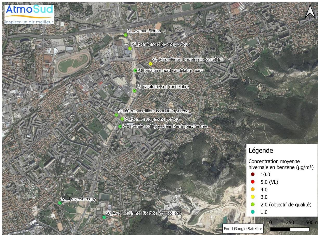
**Figure 11 : Représentation cartographique des concentrations en benzène par point de mesure
