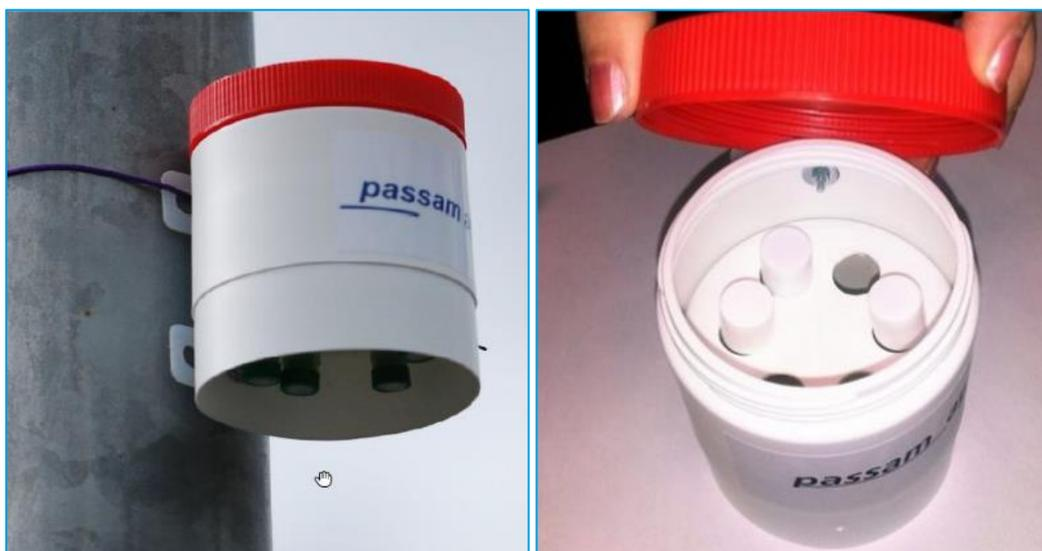
**Figure 3 : Abri spécifique pour les capteurs NO<sub>2</sub>**
