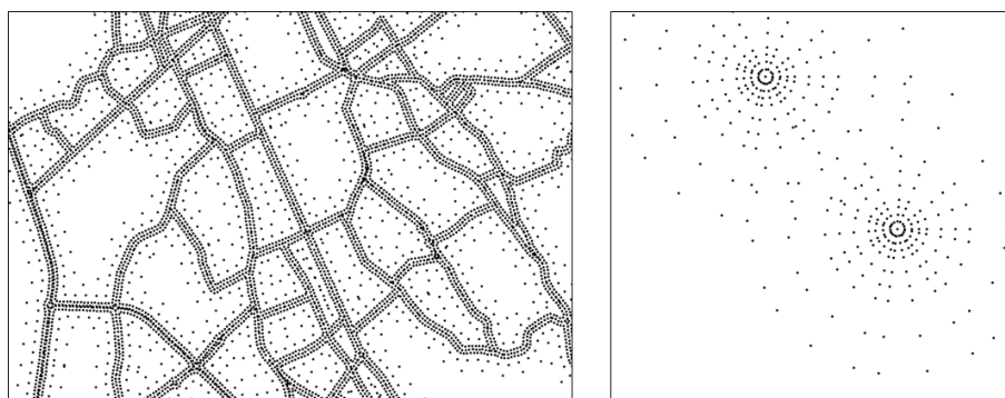
Figure 31: Exemple de positionnement des points de calculs pour le traitement des sources linéaires (gauche) et des sources ponctuelles (droite)
