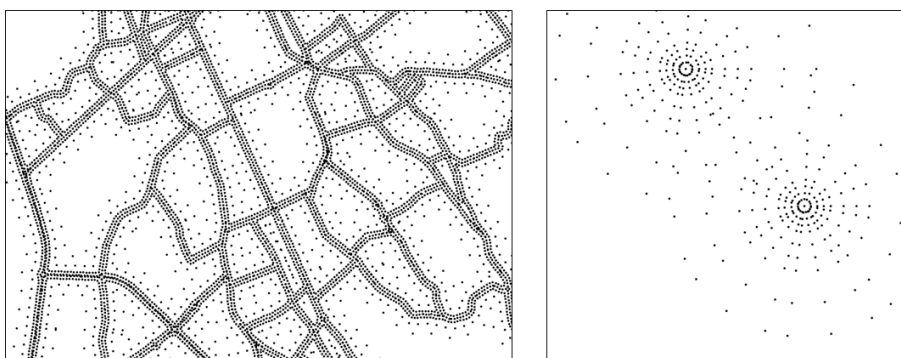
Figure 26: Exemple de positionnement des points de calculs pour le traitement des sources linéaires (gauche) et des sources ponctuelles (droite)
