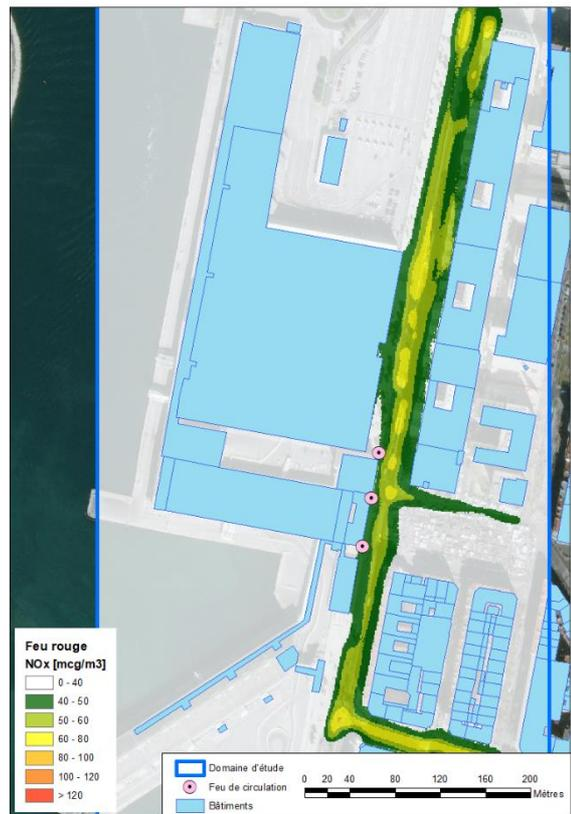
Figure 57 : Concentration en NO<sub>x</sub> pour des émissions du trafic routier résultant d'une chronique « asynchrone » des feux : phase d'accélération (haut et gauche), feux au vert (en haut et à droite), phase de freinage (en bas et à gauche), feux au rouge (en bas et à droite)
