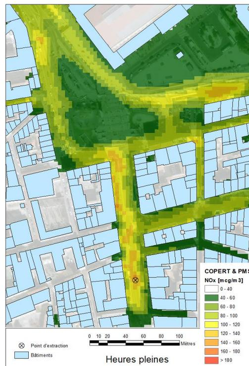
Figure 51 : 3eme zoom : moyenne heures creuses (à gauche) et pleines (à droite) en NO<sub>x</sub> avec pour des émissions du trafic routier résultant de la méthodologie AIRMES (en haut) ou COPERT (en bas)
