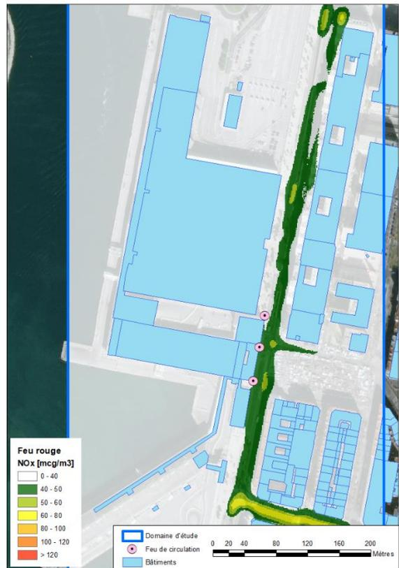
Figure 60 : Concentration en NO<sub>x</sub> pour des émissions du trafic routier résultant d'un parc VP 100% essence : phase d'accélération (en haut et à gauche), feux au vert (en haut et à droite), phase de freinage (bas et gauche), feux au rouge (en bas et à droite)
