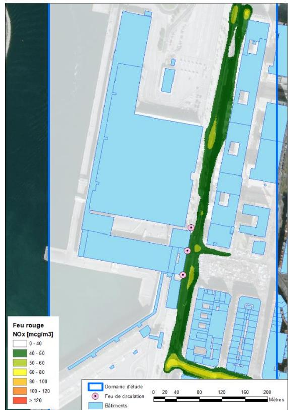
Figure 61 : Concentration en NO<sub>x</sub> pour des émissions du trafic routier résultant d'un parc VP 100% diesel Euro6D-TEMP : phase d'accélération (en haut et à gauche), feux au vert (en haut et à droite), phase de freinage (en bas et à gauche), feux au rouge (en bas et à droite)
