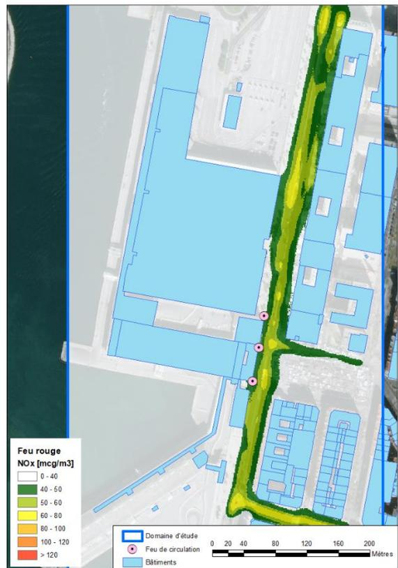
Figure 56 : Concentration en NO<sub>x</sub> pour des émissions du trafic routier résultant d'une chronique « onde verte » de synchronisation des feux : phase d'accélération (en haut et à gauche), feux au vert (en haut et à droite), phase de freinage (en bas et à gauche), feux au rouge (en bas et à droite)
