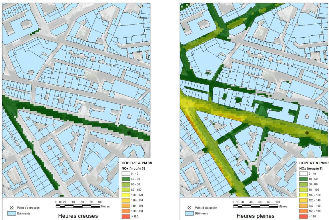
Figure 49 : 2nd zoom : moyenne heures creuses (à gauche) et pleines (à droite) en NO<sub>x</sub> avec pour des émissions du trafic routier résultant de la méthodologie AIRMES (en haut) ou COPERT (en bas)
