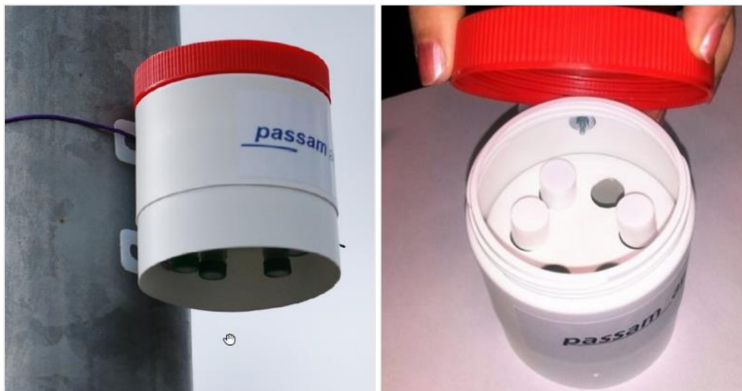
Figure 4 : Abri spécifique pour les capteurs NO 2
