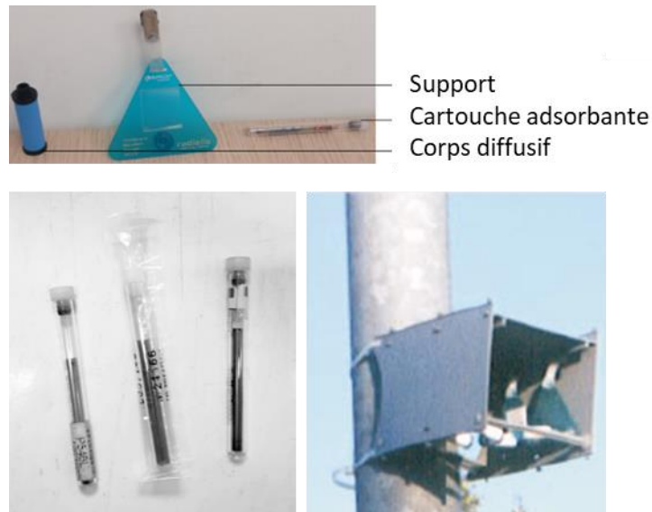
Figure 5 : Composition du matériel employé pour la mesure de BTEX
