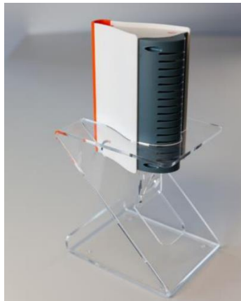
Figure 3 : Balise Fireflies (COVL, COVT, température, humidité relative, CO 2 )
