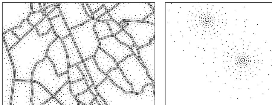
Figure 43: Exemple de positionnement des points de calculs pour le traitement des sources linéaires (gauche) et des sources ponctuelles (droite)
