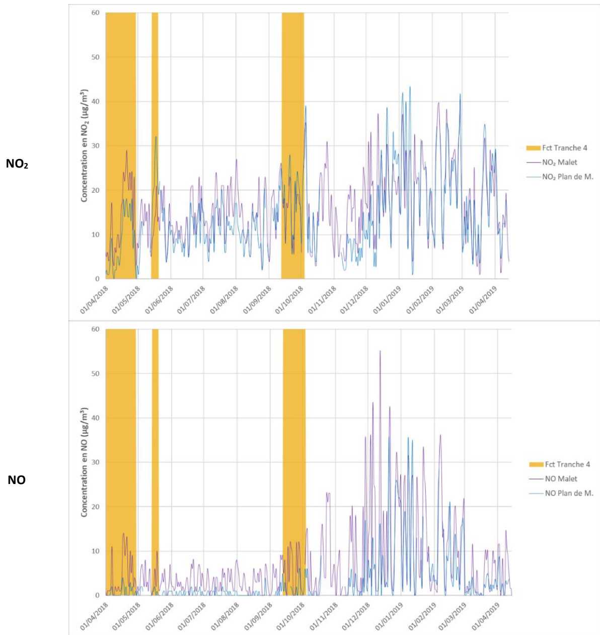
Figure 14 : Evolution de la concentration moyenne journalière en NO 2 et en NO sur l'intégralité de la campagne de mesures
