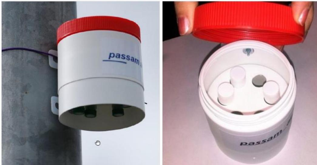
Figure 5 : Abri spécifique pour les capteurs NO<sub>2</sub>
