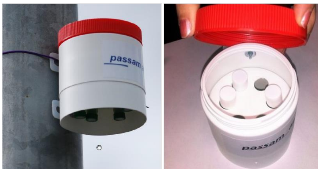
Figure 6 : Abri spécifique pour les capteurs NO 2
