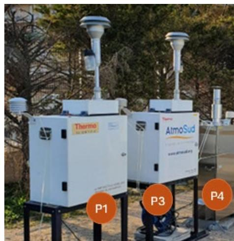
Illustration 1 : Partisols pour les prélèvements P1 et P3 (gauche et centre) et Leckel pour les prélèvements P4 (droite)
