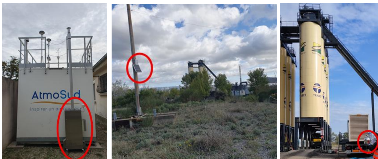
Illustration 1 : gauche : cabine de mesure sur le site de l'école avec préleveur HAP(entouré), centre : microcapteur (entouré) à la centrale d'enrobage et droite : mesure canister (entouré) à la centrale d'enrobage
