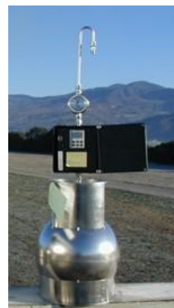
Illustration 3 : Canister pour prélèvement d'air et analyse des COV
