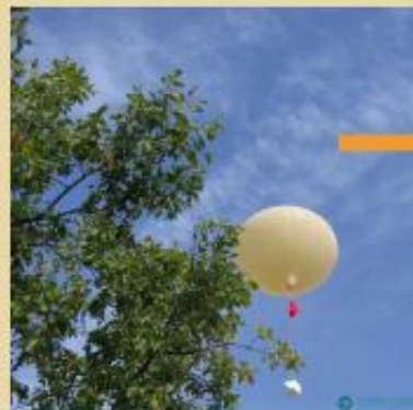
Lâcher hebdomadaire de ballon météorologique pour mesurer l'ozone à la station Gérard-Mégie Weekly release of a weather balloon to measure ozone at the Gérard-Mégie station
