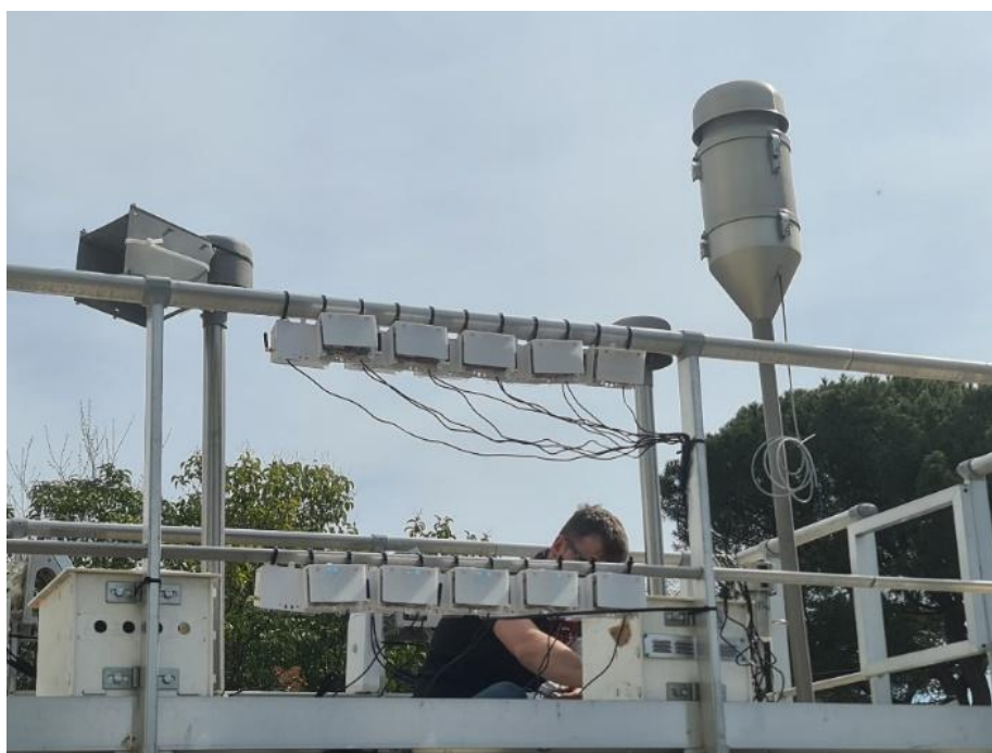
Intercomparaison et qualification de capteurs Nebule Air sur une station de référence
