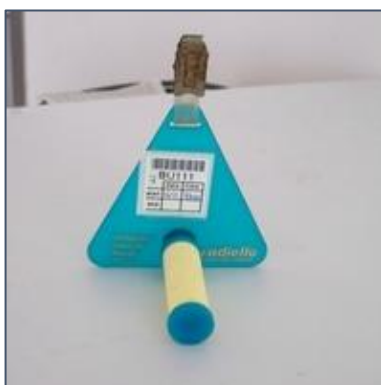
Photographie d'un tube passif Radiello utilisé par AtmoSud
