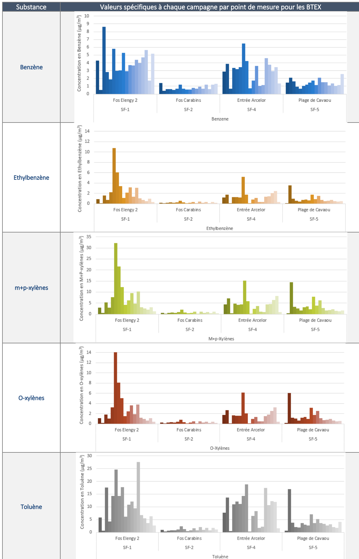
Figure 5 : Concentrations en BTEX sur les différentes campagnes selon les sites échantillonnés – Année 2025
