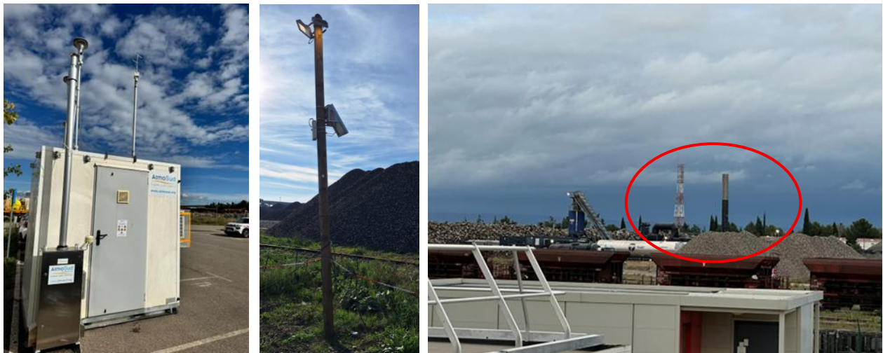
Figure 1: gauche : cabine de mesure avec préleveur HAP, centre : microcapteur à la centrale d'enrobage et droite : vue de la cabine de mesure sur la centrale d'enrobage
