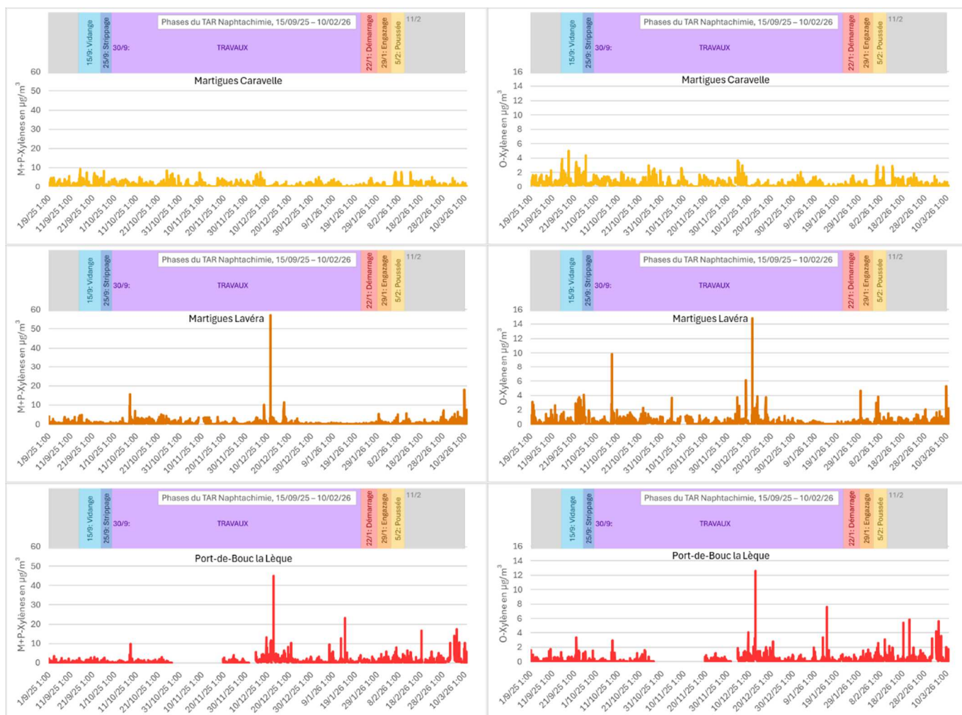
Figure 8 : Concentrations horaires de xylènes (M+P à gauche, O à droite) durant la campagne sur les trois sites de mesures
