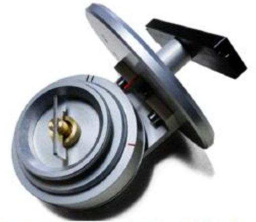
Figure 3 : Tête d'un capteur Hirst munie d'un tambour
