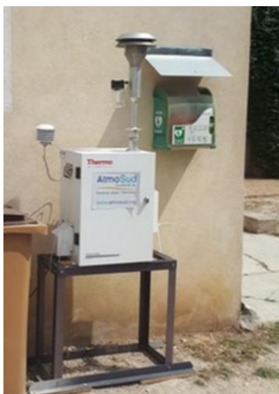
Figure 1 : Préleveur Partisol ( https://www.thermofisher.com/order/catalog/product/fr/fr/2025I )
