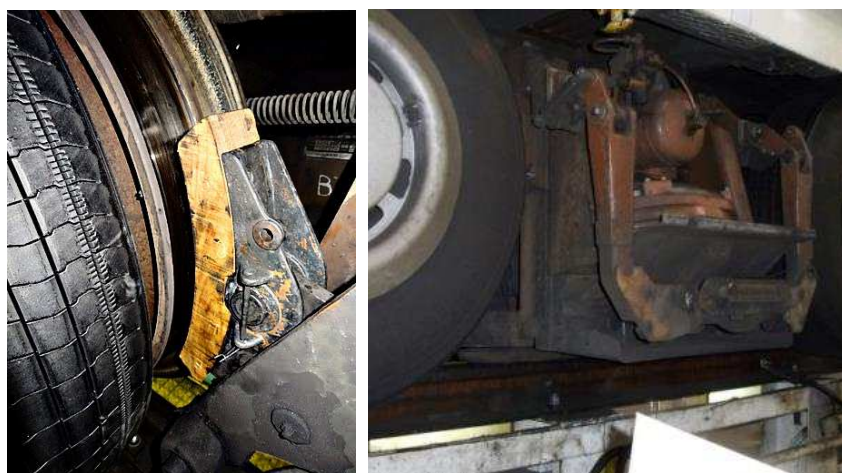
Photographie 1 : Roue pneumatique doublée d'une roue de sécurité fer avec frein mécanique à sabot en bois
